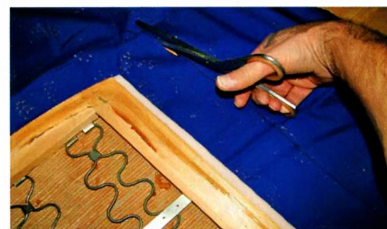
Новый поролон и обивочную ткань вырезал для сидений с небольшим припуском.
