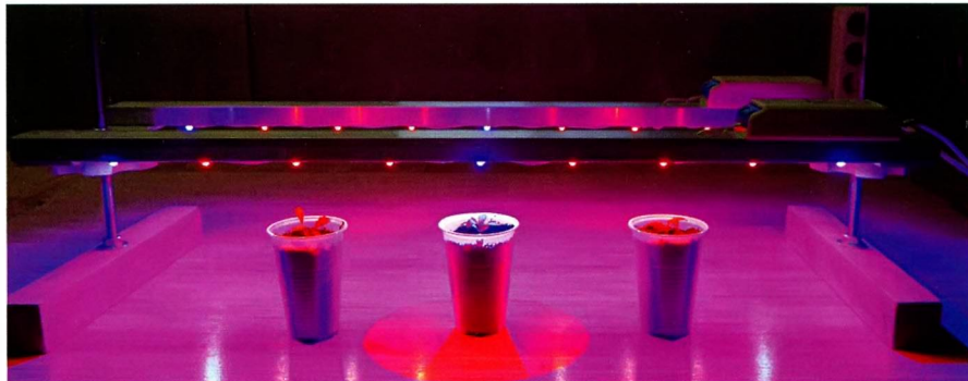
Подсветка в действии. По тени от центрального стакана с растениями виден примерный радиус освещения одним светодиодом. Синие светодиоды — более яркие, поэтому круг здесь более заметен.
