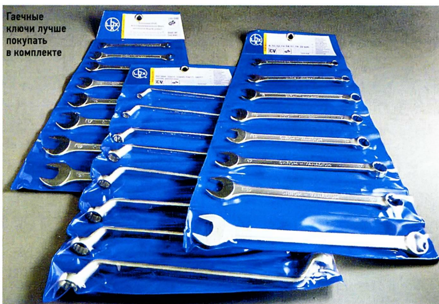
Стандартные формы: односторонний гаечный ключ с открытым зевом, двусторонний рожковый гаечный ключ, комбинированный гаечный ключ, двусторонний накидной гаечный ключ со смещением.
