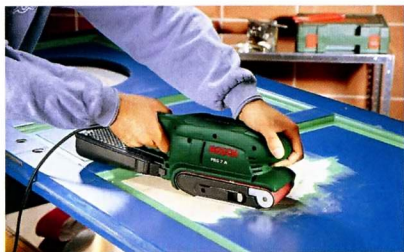
Используют ЛШМ для удаления старого лакокрасочного покрытия.
