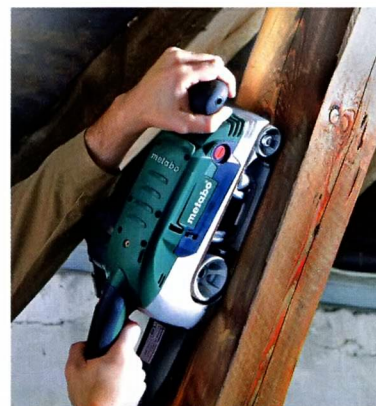
При шлифовке вертикальных или наклонных поверхностей большой вес машины может затруднить работу.
