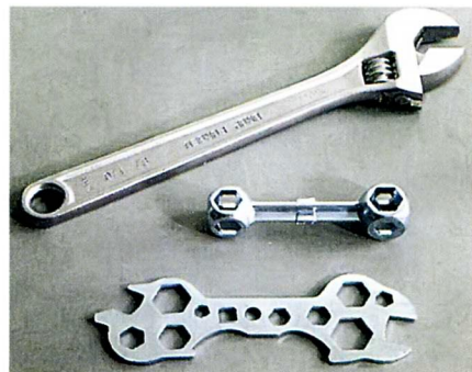
Универсальные гаечные ключи: разводной и многозевные, входящие обычно в комплект для велосипеда.
