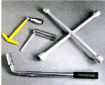
Специальные торцевые ключи для автомобилей: крестовый — для колёс, телескопический — для колёсных гаек и ключ для свечей зажигания.
