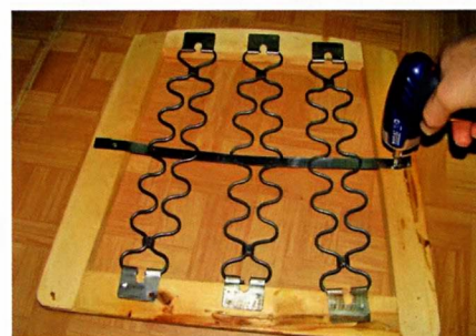
Для надёжности прикрепил перпендикулярно пружинам полоску из нержавеющей стали.
