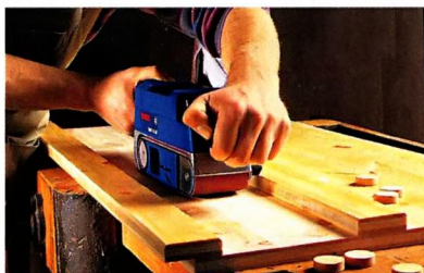
ЛШМ хорошо справляется с грубой обработкой больших поверхностей.
