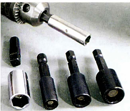
Торцевые головки для аккумуляторной дрели с размером шестигранника до 13 мм и с шестигранным хвостовиком 1/4", которым их вставляют в патрон. С соответствующим адаптером к ним подойдут и насадки для торцевых ключей.
