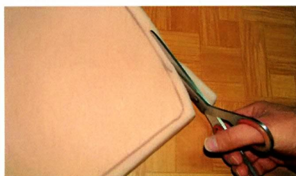
Новый поролон и обивочную ткань вырезал для сидений с небольшим припуском.
