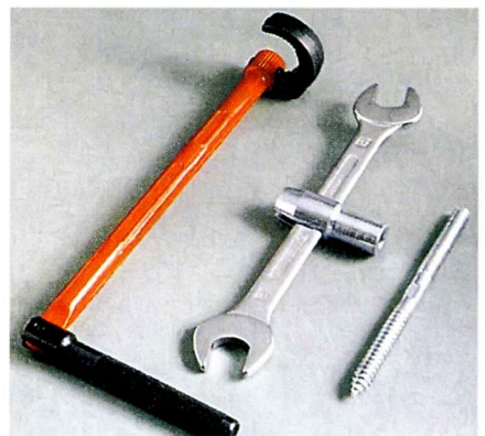
Специальный сантехнический ключ и ключ для ввинчивания шпилек (с разной резьбой с двух сторон).
