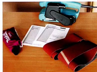
Ширина и длина шлифовальной ленты подбирается к каждой модели ЛШМ согласно инструкции.
